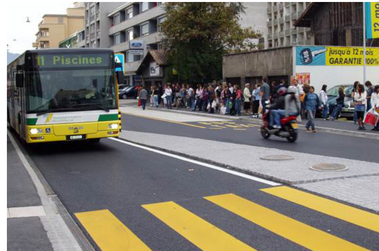
Arrêts de bus avec îlot central et traversée piétonne sécurisée à Neuchâtel (NE) (source : mrs)
