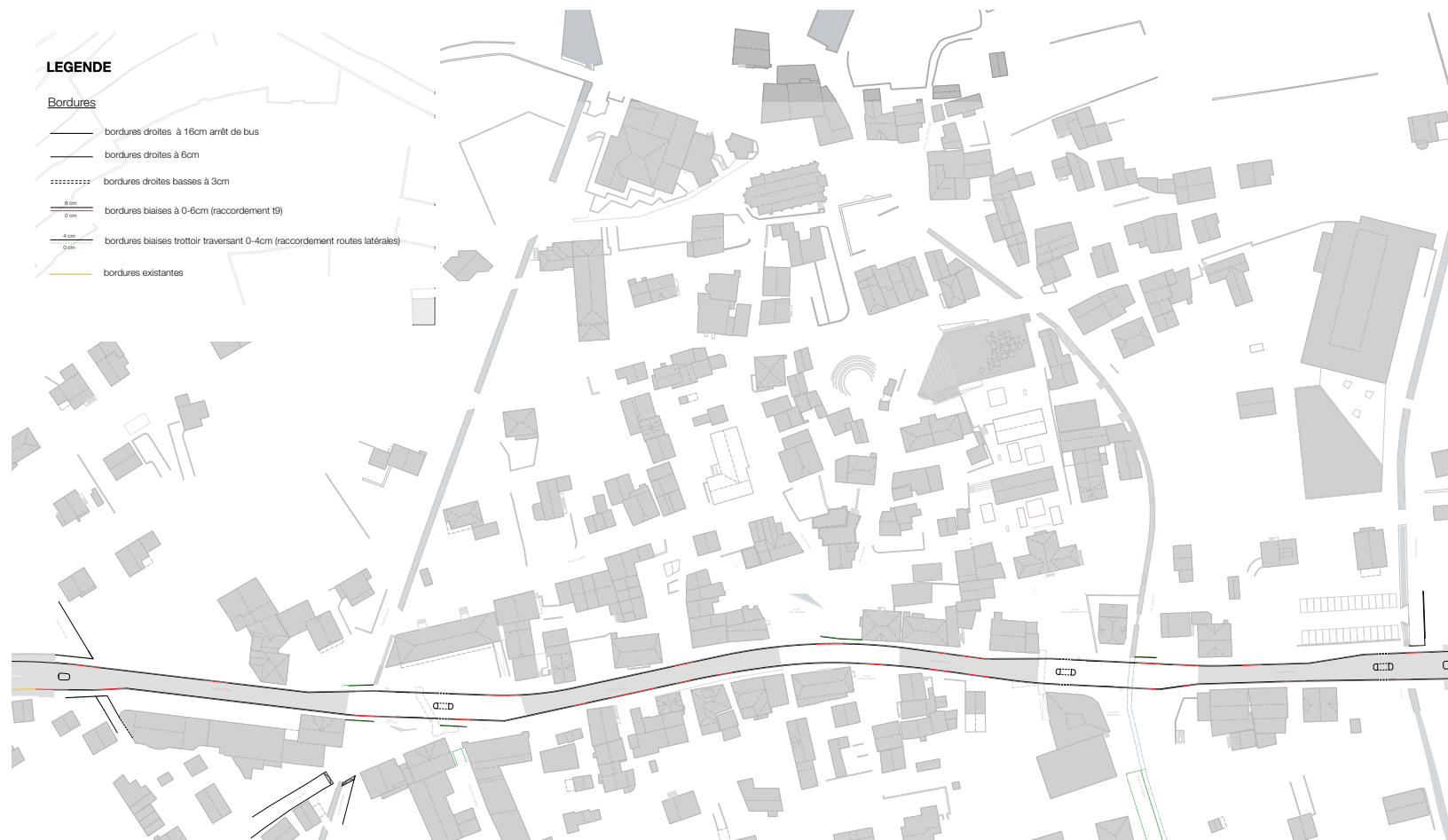
Plan schématique des abaissements de bordures le long de la route cantonale
